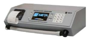
Малогабаритный анализатор концентрации паров этанола с бортовым питанием 12B для работы на мобильных постах
