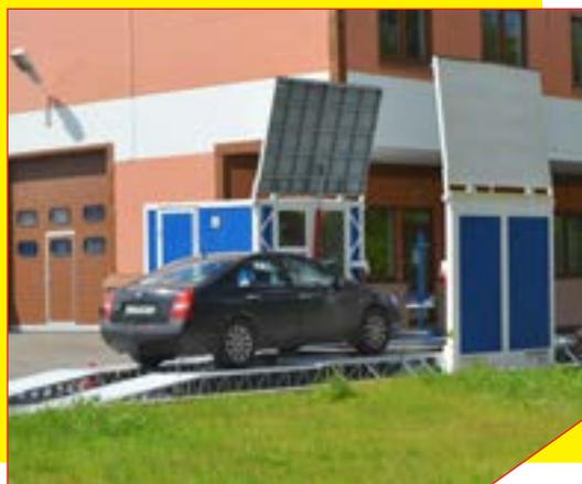
**МСД-3500** универсальная контейнерная станция для проверки технического состояния легковых автомобилей, микроавтобусов и мини-грузовиков с нагрузкой на ось до 3 500 кг.
