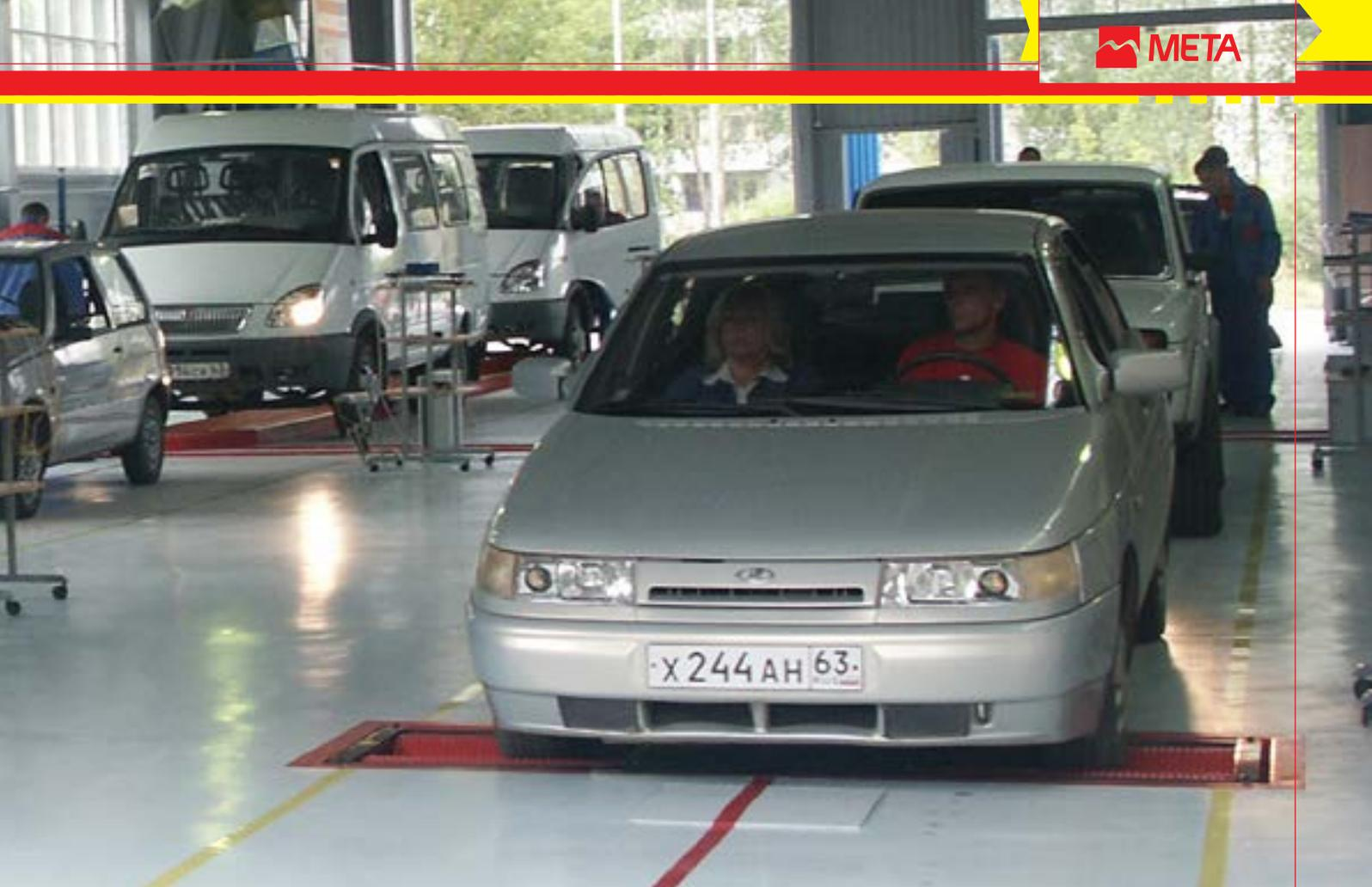
**ЛТК-С 10000** — автоматизированная универсальная линия технического контроля для проверки технического состояния грузовых и легковых автомобилей, а также микроавтобусов с нагрузкой на ось до 10 000 кг.
