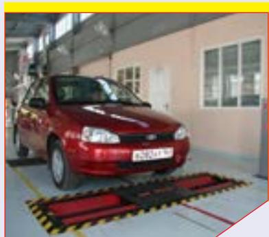
**ЛТК-С 3500 М** — линия технического контроля для проверки технического состояния легковых автомобилей и микроавтобусов, в том числе полноприводных, с нагрузкой на ось до 3 500 кг.
