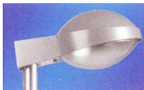
Светильники с зеркальными натриевыми лампами высокого давления мощностью 150 и 250 Вт и световым потоком 14000 и 26000 лм на опорах высотой 8-10 м с шагом установки 55 м
