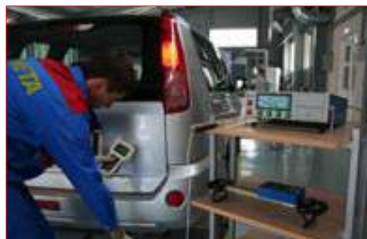
Многокомпонентный газоанализатор для измерения концентрации CO, CO 2 , CH, O 2 , NOx, частоты вращения коленчатого вала при проверке токсичности отработавших газов автомобилей АВТОТЕСТ
