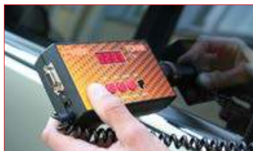
Измеритель светопропускания стекол для определения светопропускания стекол тонированных и затемненных различного назначения ТОНИК
